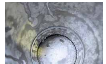
■ Verschmutzung Contamination / soiled valve body
